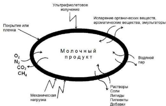
Рис. 2 - Факторы, относительно которых биоразлагаемые пленки, используемые для упаковки молочных продуктов, должны обладать барьерными свойствами [8, 9]
