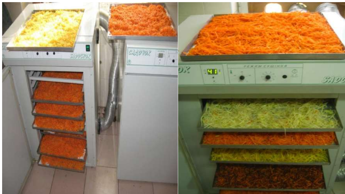
Рис. 1 - Конвективная сушилка, которую использовали для сушки корнеплодов моркови
