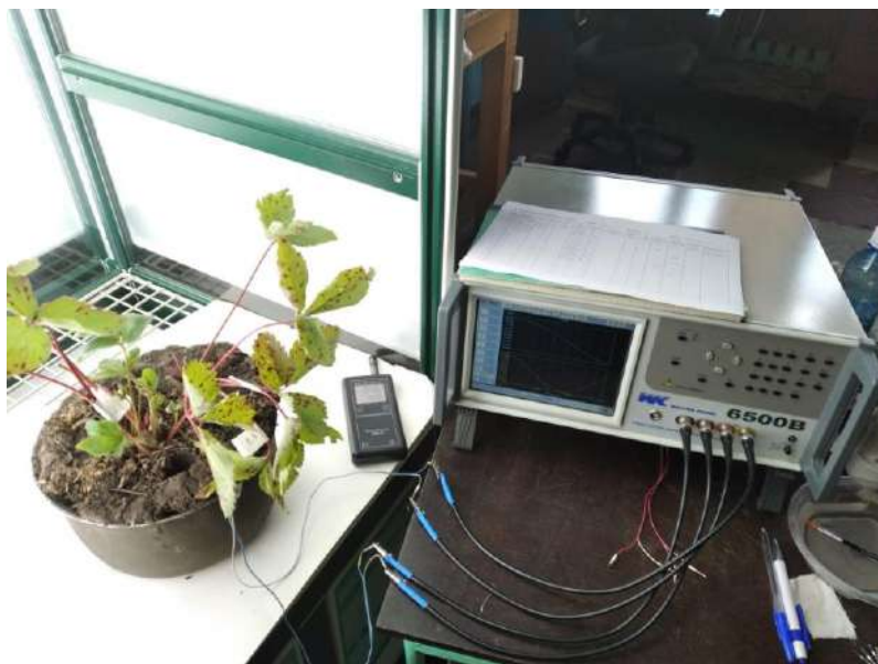
Рис.1- Внешний вид измерительной установки импеданса растительной ткани
